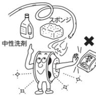
▲ **注意** ■ 洗車機の使用、高圧洗浄、スチーム洗浄の場合、ホイールに傷が付いたり変色したりする事があるので、お手入れはなるべく手作業で行ってください。また、粗い磨き砂の入った工業用洗剤はホイールを傷付ける事がありますので避けてください。手作業によるお手入れ時、ホイールや部品で怪我をしない様注意してください。
