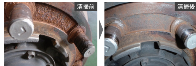
ハブやボルトに錆や汚れが付着し、確実な車輪取り付けができない状態
