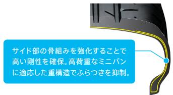
サイド部の骨組みを強化することで高い剛性を確保。高荷重なミニバンに適応した重構造でふらつきを抑制。
