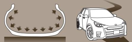
構造設計の最適化により路面からの振動を吸収。走行中の小さな振動に加え、段差乗り越し時の大きな振動を大幅に低減。
