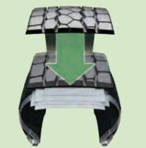
一次寿命が終了したタイヤのトレッドゴム (路面と接する部分のゴム) の表面を決められた寸法に削り、その上に新しいゴムを貼り付け、加硫<sup>※</sup>再利用 (リユース) するものです。台タイヤを再利用できるので省資源に貢献します。
